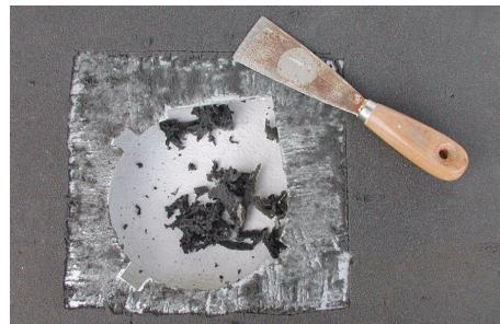
④ **Von der Unterseite Gehäuseboden Fingerschutz lösen und Isolierbelag entsprechend der Größe der beiden Isolermatten entfernen**
