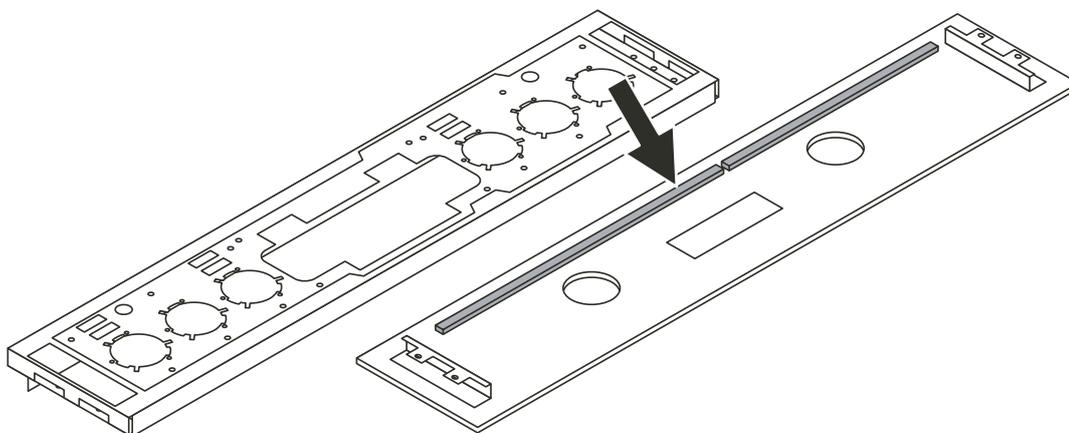
2. Coller un nouveau joint en mousse (suivre l'illustration) dans l'encoche réalisée le long du contour du déflecteur en tôle.
