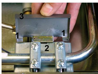
3. Pour le GKS 300 gaz et le GKS 300 WOK, glisser le Service Set en place, de manière à ce que les surfaces (1) reposent sur la tôle support (2). La surface supérieure (3) de la tôle support se cale une fois la plaque de fond revisée.
