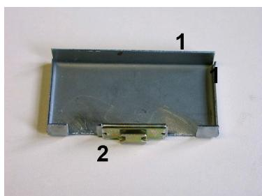
2. Le Service Set se compose d'une tôle support (1) et d'un ressort (2). Pour le GKS 300 WOK (fabrication avant septembre 2003), utilisez le Service Set hauteur 54,5 mm, pour tous les autres types, utilisez le Service Set hauteur 39,5 mm.
