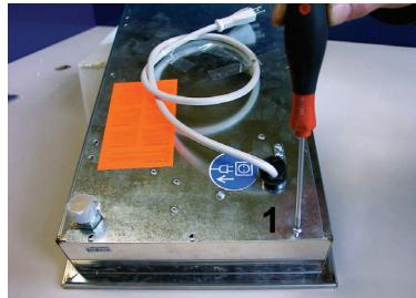
1. Pour mettre en place le Service Set, démontez le GKS/GWS. Déposer le GKS/GWS sur une surface adéquate, de manière à pouvoir accéder à la plaque de fond et sans que les manettes n'appuient sur la surface. Dévissez la plaque de fond (1).
