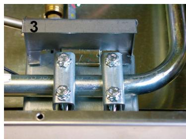
4. Pour le GWS 457.0 WOK, deux Service Sets sont utilisés et placés de manière à ce que les surfaces (comme illustré dans fig. 3) reposent sur les deux tôles support. Les surfaces supérieures (3) des tôles support se calent contre la face intérieure de la plaque de fond une fois celle-ci revisée.
