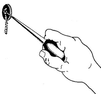
Le montage nécessite de retirer toutes les pièces du bas. On ôte alors le support trop court ou défectueux en utilisant un marteau et un ciseau ou une spatule acérée. Retirer ensuite la mousse avec un alésoir ou autre à travers l'orifice ainsi obtenu, jusqu'à ce que le kit de réparation s'insère sans problème.
