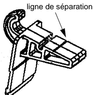
Si le support est cassé ou brisé mais que l'écart entre les parois latérales est correct, le nouveau support doit être raccourci au niveau de la ligne de séparation.
