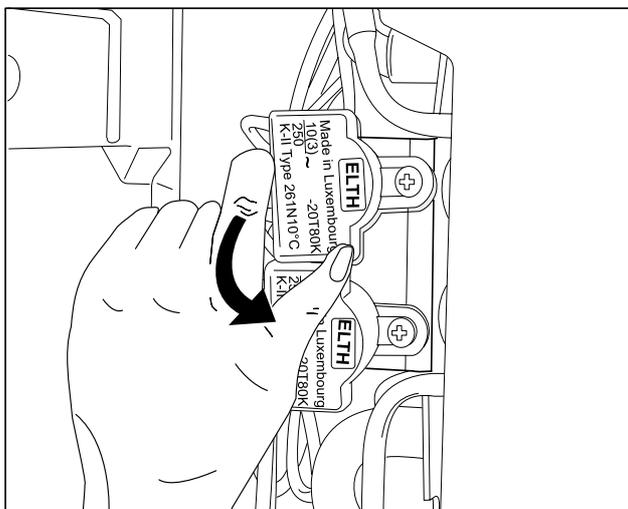
Plier légèrement vers l'avant le collier de fixation sur lequel est placé l'interrupteur du thermostat de dégivrage afin que ces interrupteurs ne se trouvent pas en contact direct avec le courant d'air de la résistance de chauffage de l'évaporateur.
