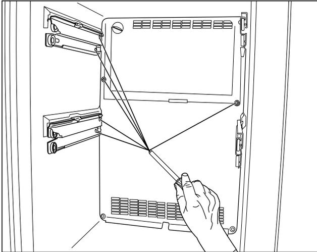
Desserrer les vis et démonter les deux glissières situées sur un côté.
