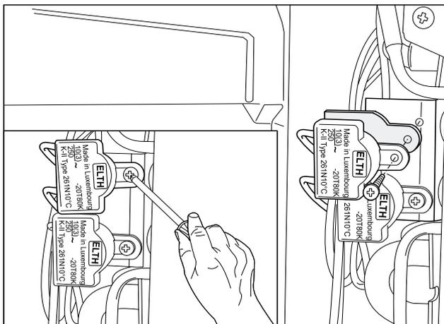
Desserrer l'interrupteur du thermostat destiné au dégivrage (thermostat supérieur).
