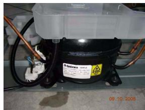
Passer le tuyau souple d'écoulement derrière le compresseur, comme montré dans l'illustration.
