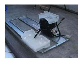
Couper la partie du tuyau qui dépasse et fixer ce dernier à l'aide d'un collier de serrage sur le bac de récupération.
