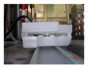
Positionner le bac de récupération du kit à hauteur de la traverse qui se trouve devant le compresseur.
