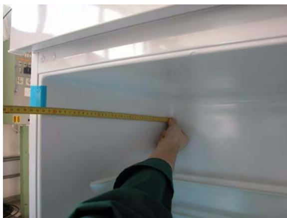
1. Chercher le creux caractéristique aménagé dans le compartiment réfrigérateur. L'évaporateur à tube commence en dessous.
