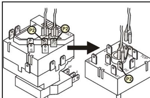
2. Il conduttore del contatto 4 e 4a sull'interruttore sovrapposto del vecchio regolatore viene inserito sul contatto 4 e 4a presente sul lato posteriore del nuovo regolatore. Viene a mancare il ponte X del contatto 4 dell'interruttore sovrapposto con il contatto 4 sul lato posteriore del vecchio regolatore.
