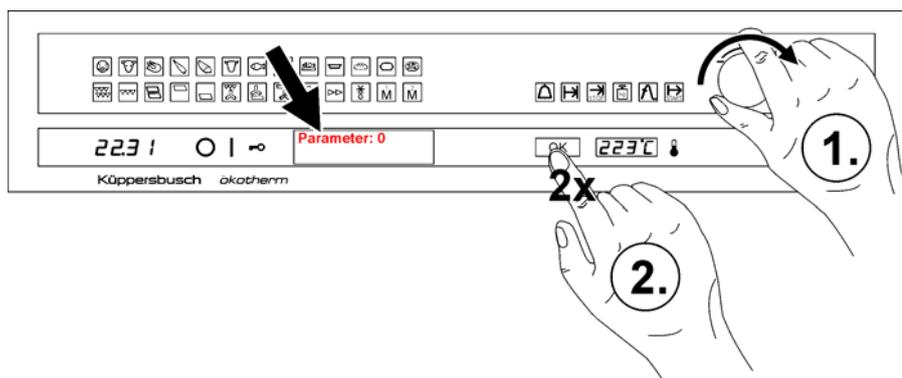
Ruotare il selettore finché sul display non compare PARAMETRO: 0 e confermare due volte con OK.
