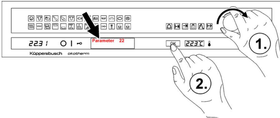
Ruotare il selettore finché sul display non compare PARAMETRO: 22 e confermare con OK.
