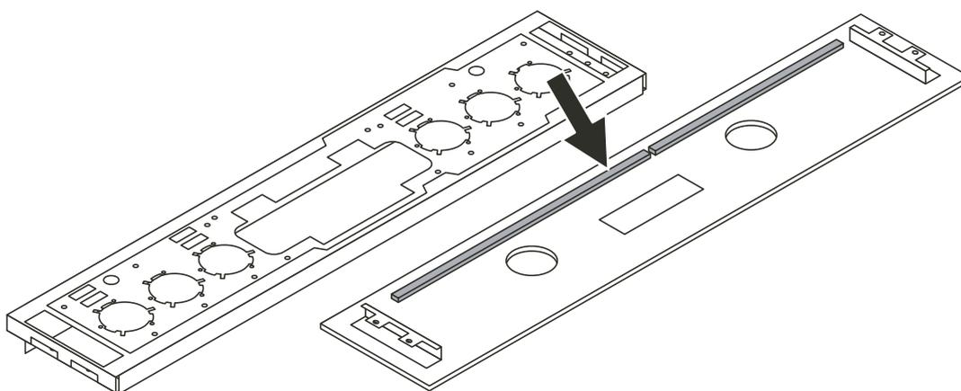
2. Incollare la guarnizione in gommapiuma come mostrato, premendola lungo il contorno della scanalatura presente sulla lastra di metallo.
