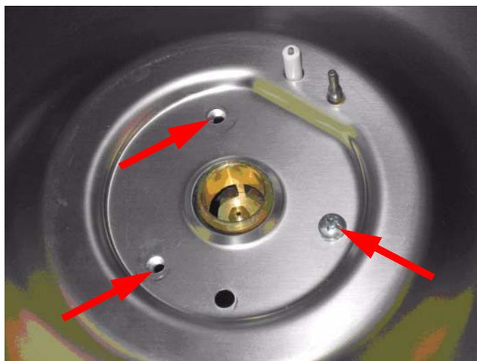
Una volta avvitate, svitare la 3 viti di fissaggio di  $\frac{1}{4}$  a  $\frac{1}{2}$  giro.
