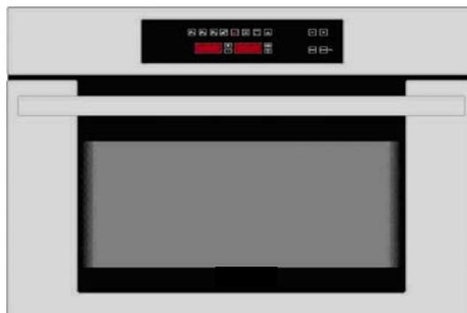
Anche nel caso in cui la porta sia già montata, è possibile allinearla. Affinché la porta non sia più in tensione occorre allentare il supporto cerniera (ricambio N° 528895). La porta andrà quindi regolata in modo tale che la distanza fra la porta e il pannello di comando sia di 7 mm. Infine stringere nuovamente le viti.
