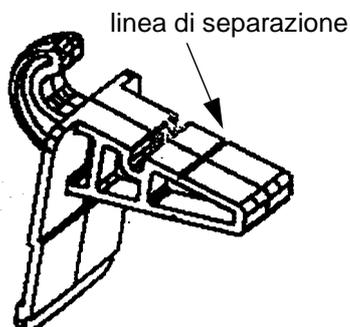
Quando il supporto è rotto o spezzato ma la distanza tra le pareti laterali è corretta, accorcire il nuovo supporto all'altezza della linea di separazione.
