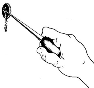
Rimuovere tutti i componenti della parte inferiore prima di effettuare il montaggio. Rimuovere quindi il supporto difettoso o troppo corto utilizzando un martello insieme ad un ferro troncatore o ad uno scalpello oppure una spatola affilata. Utilizzando una lesina, o un utensile simile, estrarre la schiuma dall'apertura formata, in modo da poter inserire il supporto di riparazione senza difficoltà alcuna.
