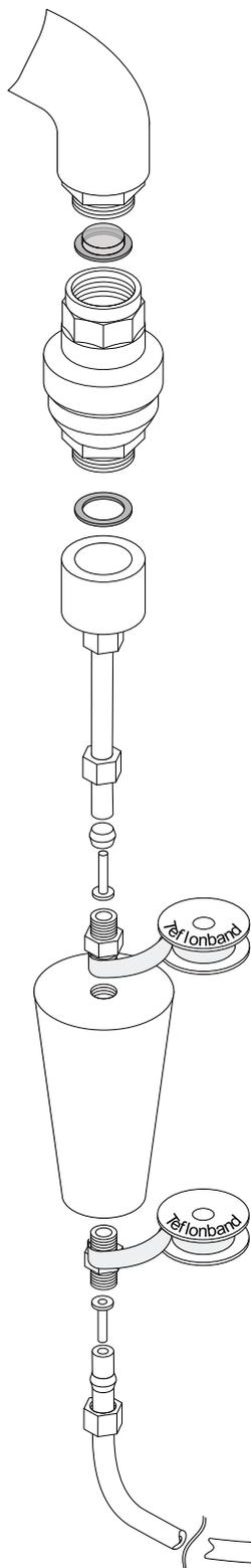
Valvola di collegamento dell'apparecchio con valvola non-ritorno integrata (**esistente da parte del cliente**)
