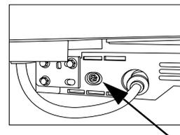
Regolazione dell'altezza della ruota; il lato destro si regola allo stesso modo.
