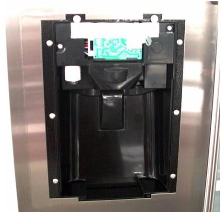
Con l'asciugacapelli riscaldate da fuori i punti d'incollo del rivestimento porta (per le posizioni fare riferimento alla porta nuova). Con aiuto di un cacciavite piano togliete ora il rivestimento metallico ed eventuali residui di colla. Applicate adesso il rivestimento nuovo pressando fortemente i punti d'incollo con le mani. Il montaggio dell'apparecchio avviene in ordine inversa.
