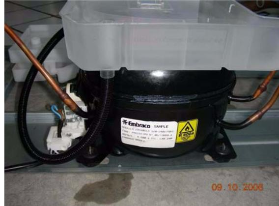
3. Inserire il tubo di scarico dell'acqua nella vaschetta evaporante che si trova sul compressore.
