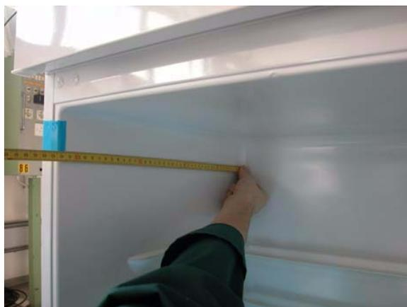
1. Cercare la tipica rientranza nel vano frigorifero, sotto cui si trova l'evaporatore tubolare.
