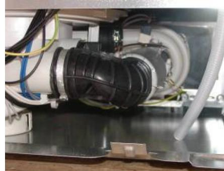
Hiervoor kunt u met een schroevendraaier lichtjes tegen de slang drukken en zien hoe de slang zich gedraagt, of u schakelt de afwasmachine tijdens de spoelcyclus uit en dan weer in. Als de slang eraf glijdt, moet de slangbocht worden vervangen. Het is niet voldoende de slang weer in te steken omdat de slang verbogen is en telkens weer zou weglijden.
