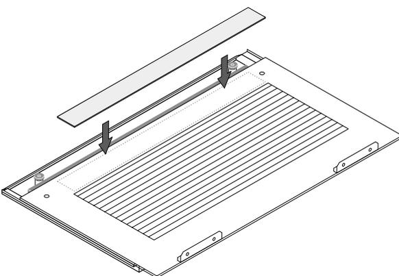
Retirar a película de protecção da tira metálica e colar entre os dois furos de fixação da asa da porta na parte inferior do vidro frontal.
