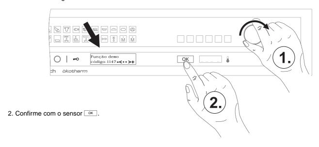
1. Pode ligar a função de demonstração rodando (rodar para a direita) ou desligá-la (rodar para a esquerda).
