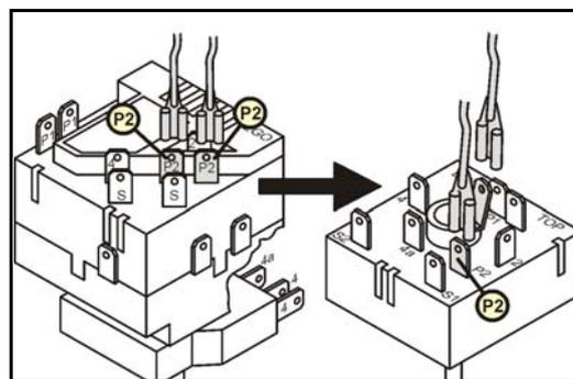
2. O fio do contacto 4 e 4a do interruptor sobreposto do regulador antigo é introduzido no contacto 4 e 4a situados do lado traseiro do novo regulador. Suprime-se a ponte X do contacto 4 do interruptor sobreposto para o contacto 4 situado do lado traseiro do regulador antigo.
