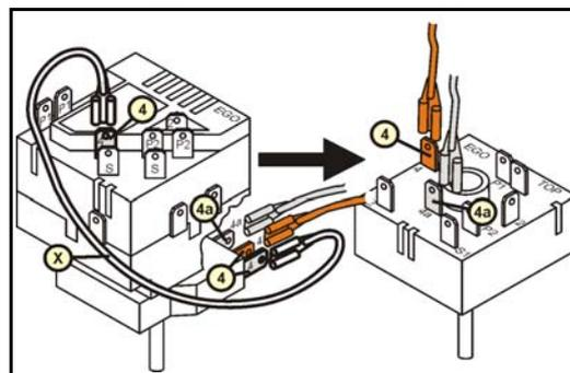
3. O contacto 2x S do regulador antigo é um contacto isento de potencial para o indicador luminoso, que está identificado com S1 e S2 no novo regulador.
