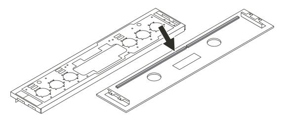
2. Colar a vedação de espuma nova, como é mostrado na ilustração, na cavidade ao longo do contorno no painel de metal.
