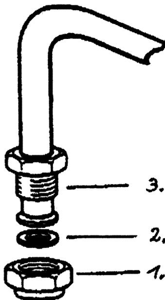
A substituição da porca cega [1] precisa ser efectuada da seguinte forma:
