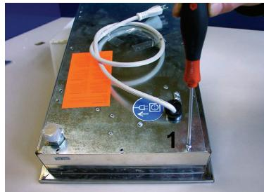
1. Para a utilização do conjunto de serviço, desmonte o GKS/GWS. Coloque o GKS/GWS numa superfície adequada, de forma a que o fundo esteja acessível e os manípulos não façam pressão sobre a superfície. Desaparafuse o fundo (1).
