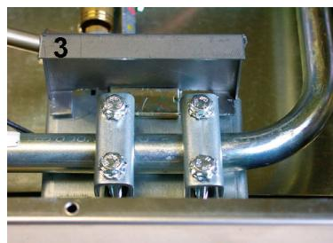
4. No GWS 457.0 WOK são usados 2 conjuntos de serviço e colocados de forma a que as superfícies (como indicado em 3) fiquem sobre as duas chapas de suporte. As superfícies superiores (3) das chapas de suporte ficam apoiadas no lado interior do fundo depois de este ser aparafusado.
