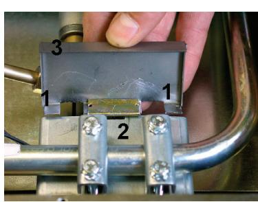
3. O conjunto de serviço no GKS 300 Gas e no GKS 300 WOK é encaixado de forma a que as superfícies (1) fiquem sobre a chapa de suporte (2). A superfície superior (3) da chapa de suporte fica apoiada depois de aparafusar o fundo.
