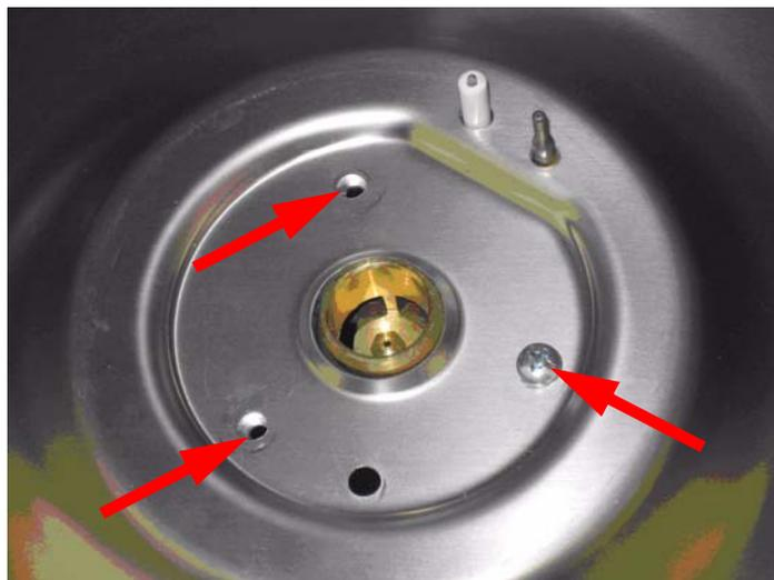
Soltar os 3 parafusos de fixação dos queimadores com um terço até meia rotação depois de os aparafusar bem.
