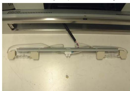
Para a instalação das novas bases de lâmpadas é preciso tirar primeiro o vidro da iluminação. Desaperte a seguir os parafusos da base da lâmpada e, por fim, separe a conexão eléctrica.
