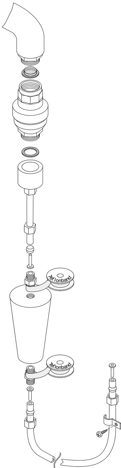
Válvula de ligação do aparelho com impedor de refluxo integrado.
