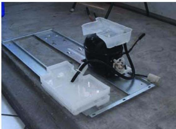
5. Corte a parte da mangueira que sobra e fixe-a ao recipiente colector de gotas com uma fita para mangueira.
