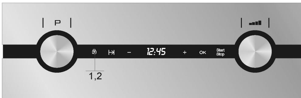
1. Zum Blockieren halten Sie die Taste Kindersicherung 3 Sekunden lang gedrückt. In der Anzeige erscheint die Sicherheitsverriegelungsleuchte. Wird nun eine Taste gedrückt, erscheint in der
