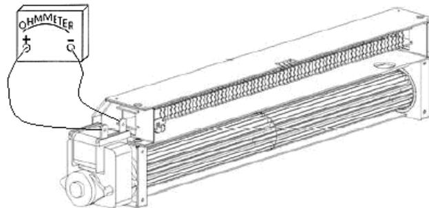
Durchgang des Thermoelements und Sicherungsthermostat:
