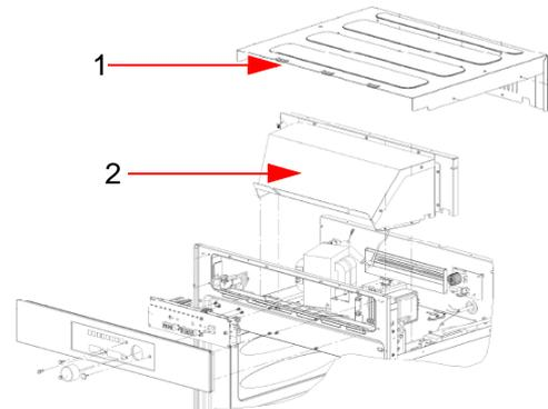
3. Nach Abschluss dieser zwei Schritte ist der Zugang zur Lagerung der Lampenhalterung möglich. Seitliche Crimps der Lampenhalterung mit Hilfe eines Schraubendrehers nach unten drücken wie in der Abbildung dargestellt.
