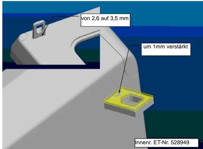
Durch diese Verbesserungen kann die Schließplatte mechanisch gut funktionieren und ist besser stabilisiert. Extreme Positionen werden durch den Haken verhindert, ohne dass die Schließplatte in die Sicherheitsposition gelangen kann, wenn der Haken ausgehakt ist. Haken wurde verstärkt, wodurch die Bruchgefahr reduziert wurde.
