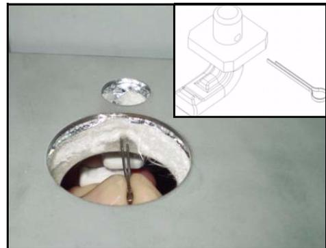
5. Durch die Lampenfassung setzen Sie nun den Splint in die Öffnung.
