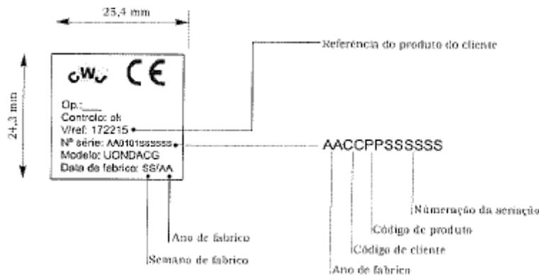
Kennzeichnung der Seriennummer des Gerätes (auf der Bedienblende geklebtes Leistungsschild)
