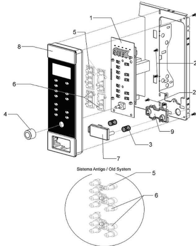
**Hinweis:** Bei der Montage des Bedienfeldes TMW 20.2 BIS muss zuerst die Encoder-Taste eingesetzt werden und erst danach sollen die Tastensätze eingesetzt werden.
